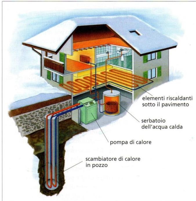
Impianto geotermico domestico con sonde verticali.
